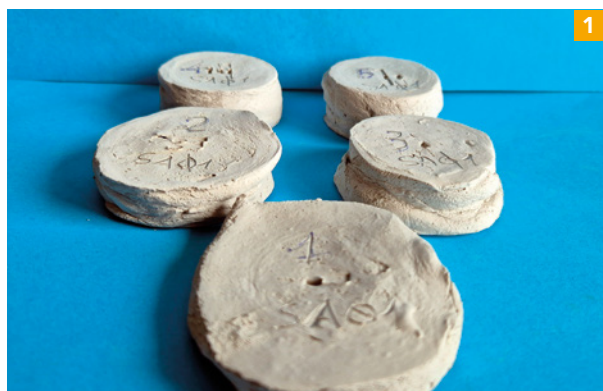
Sa01 Clay: Pfefferkorn test specimen Argilla SA01: Campioni del test di plasticità Pfefferkorn
