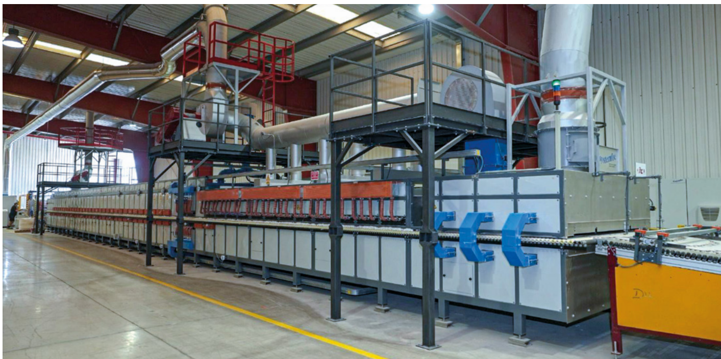
The 100% electric kiln installed at Equipe Cerámicas - Il forno 100 elettrico installato in Equipe Cerámicas
