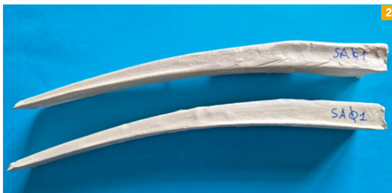
SA01 Clay: Pyroplastic bending Argilla SA01: Deformazione Piroplastica
