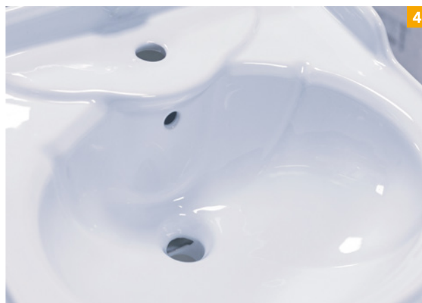
Production test of a washbasin produced using SA01 clay - Test di produzione di un lavabo prodotto con impiego di argilla SA01
