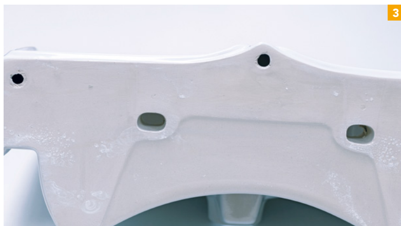
Production test of a washbasin produced using SA01 clay - Test di produzione di un lavabo prodotto con impiego di argilla SA01
